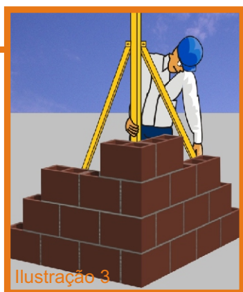
Ilustrações 3 e 4: Escantilhão e régua prumo-nível (simplificação de tarefas executivas e facilidade de controle do processo). Ilustração 5: Batente-verga pré-moldado (facilidade de integração entre subsistemas).
