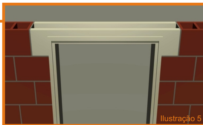
Ilustrações 3 e 4: Escantilhão e régua prumo-nível (simplificação de tarefas executivas e facilidade de controle do processo). Ilustração 5: Batente-verga pré-moldado (facilidade de integração entre subsistemas).
